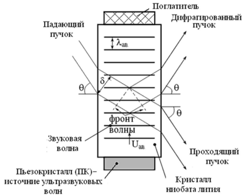
Схема прохождения пучка света в акусто-оптическом модуляторе
